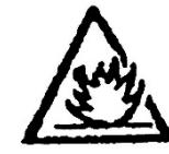
**ADVERTENCIA:** ¡Peligro de incendio! Si el equipo de aire caliente se dejara funcionando sin supervisión, los objetos cercanos podrían inflamarse. El equipo siempre debe funcionar bajo supervisión. Coloque siempre el equipo desconectado en posición vertical para que se enfrie. Deje que el equipo se enfrie por completo.
